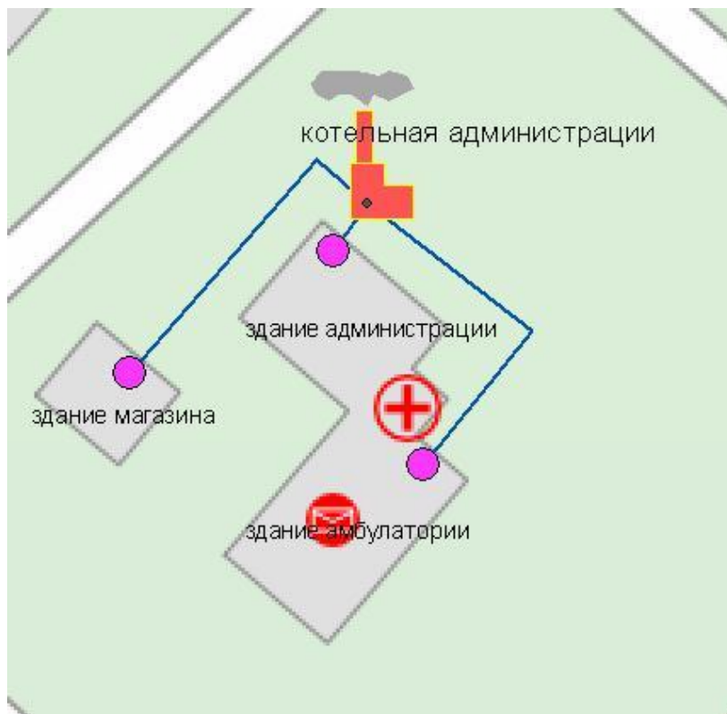
Рисунок 2.1 – Схема теплотрассы котельной с. Покровка (котельная администрации)
